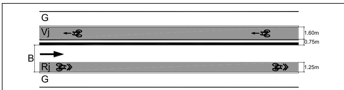
8.2.12. attēls. Velojosla ar apsteigšanas iespējām uz vienvirziena ielas (ceļa) pretēji atļautajam braukšanas virzienam, V_{atļ} \leq 30 km/h
